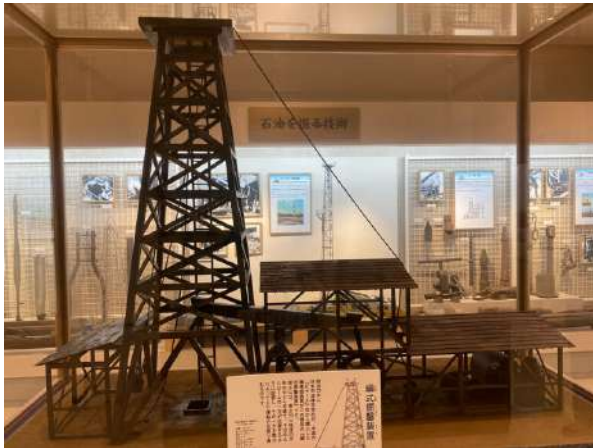
綱掘式掘削装置の模型 天領の里石油記念館にて
